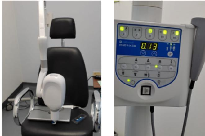
**Imagen 2.** Geometría para la medición de kerma en aire incidente. Fuente: Elaboración propia.
